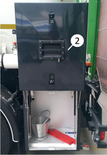
Otobüs bagaj takım dolabı kapağı
