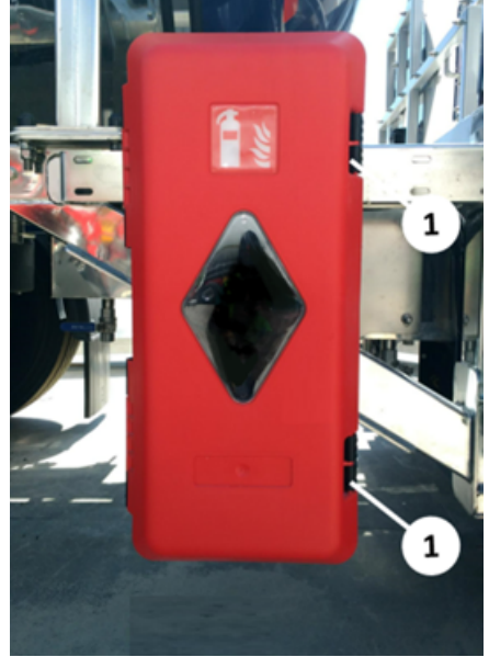
Yangın söndürme tüpü dolabı
