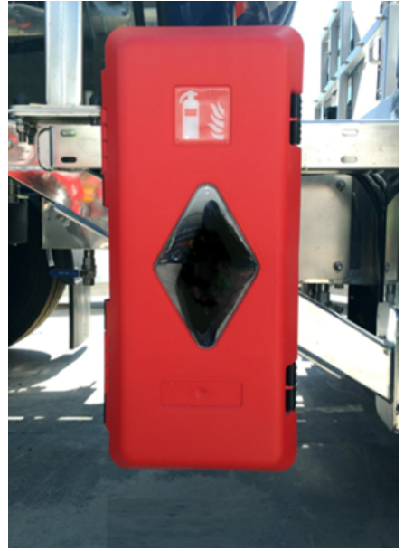
Yangın söndürme tüpü dolabı
