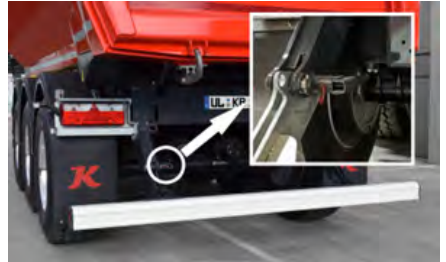
Kalkar tamponun kaldırılması
