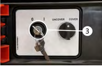
Branda kontrol ünitesinin kapatılması
