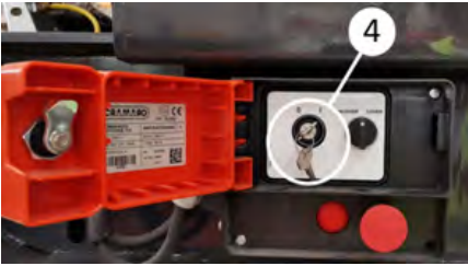
Branda kontrol ünitesinin açılması
