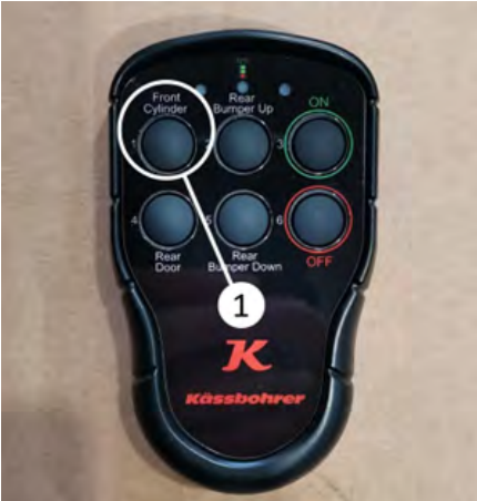
Uzaktan kumanda üzerinden kuvetin indirilmesi
