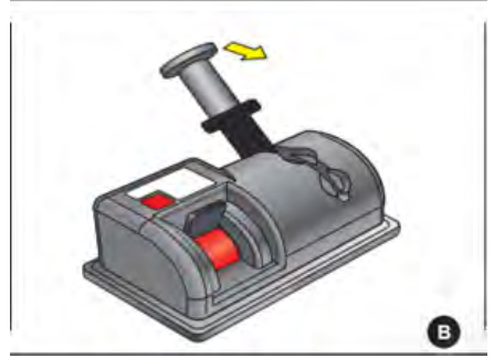
İndirme-kaldırma kolunun siyah ok yönünde çekilmesi
