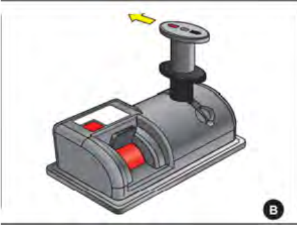
İndirme-kaldırma kolunun, kolun üstündeki kırmızı ok yönünde itilmesi
