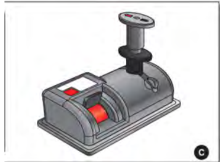
İndirme-kaldırma kolunun orta pozisyona getirilmesi
