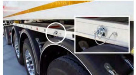
Seyyar merdiven piminin çıkarılması
