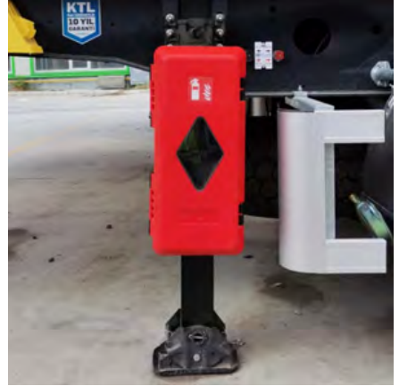
Yangın söndürme tüpü dolabı
