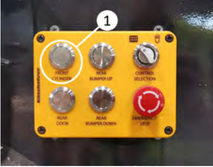
Front cylinder butonuna basılıp küvetin indirilmesi
