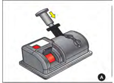
İndirme-kaldırma kolunun sarı ok yönünde bastırılması
