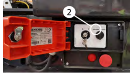
Kontrol ünitesinden brandanın açılması
