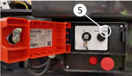
Kontrol ünitesinden brandanın kapatılması
