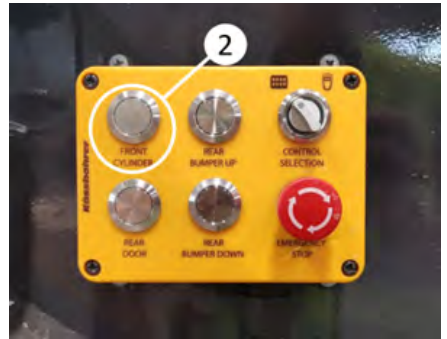
Front cylinder butonuna basılıp küvetin kaldırılması
