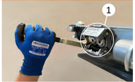
Duomatic kaplin bağlantısının yapılması
