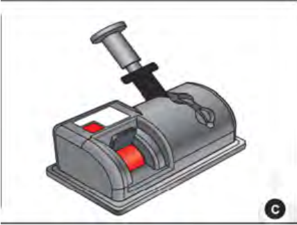
İndirme-kaldırma kolunun yuvasına oturtulması
