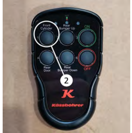
Uzaktan kumanda üzerinden küvetin kaldırılması
