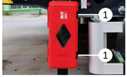
Yangın söndürme tüpü dolabının açılması
