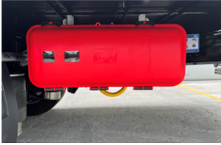
Yangın söndürme tüpü dolabı
