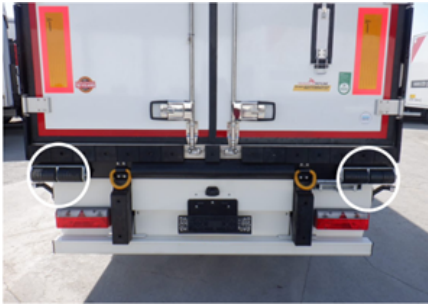
Rampa dayama takozları
