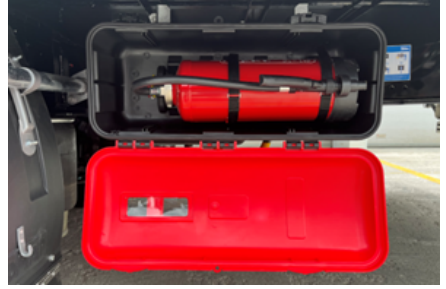
Yangın söndürme tüpü dolabının açılması
