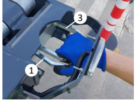
Kilit mandalının basılıp kolun çekilmesi
