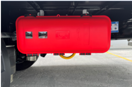
Yangın söndürme tüp dolabı
