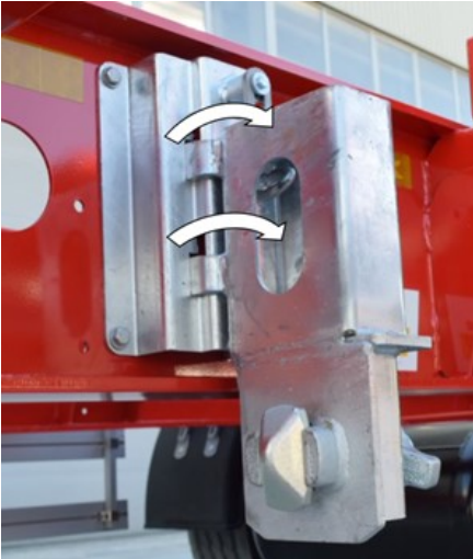
Konteyner kilit mekanizmasının çevrilmesi
