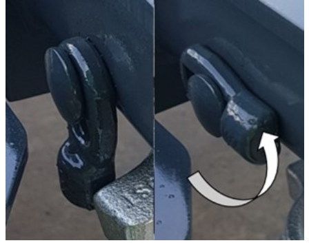
Emniyet sürgüsünün 90 derece döndürülmesi
