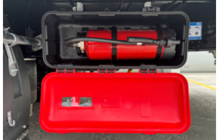
Yangın söndürme tüp dolabının açılması
