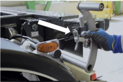
Uzatma kolunun çekilmesi
