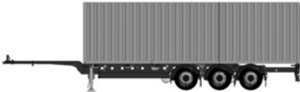
30 ft konteyner taşınaması
