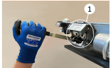
Duomatic kaplin bağlantısının yapılması
