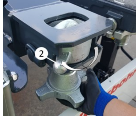
Oluk burcunun kolunun sola doğru hareket ettirilmesi
