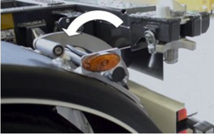
Uzatma kolunun yerine yerleştirilmesi
