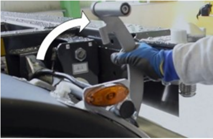
Uzatma kolunun saat yönünde çevrilmesi
