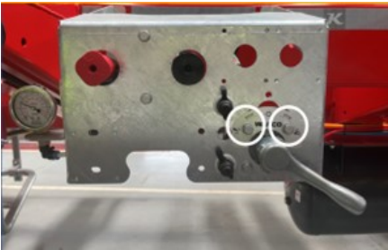
Süspansiyon yüksekliğinin sabitlenmesi
