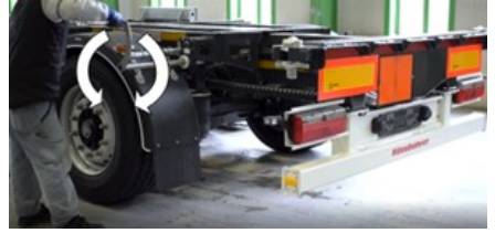
Platformun uzunluğunun ayarlanması
