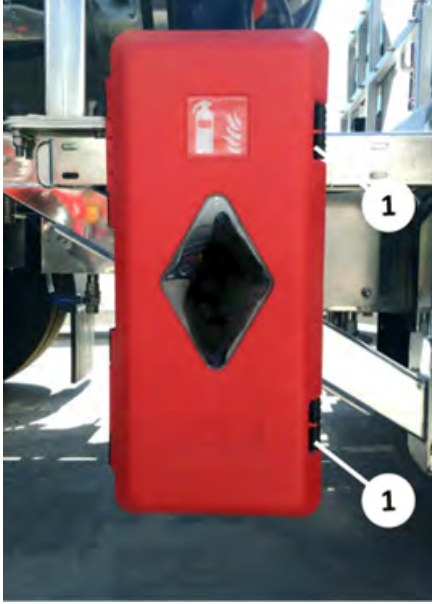
Yangın söndürme tüpü dolabı
