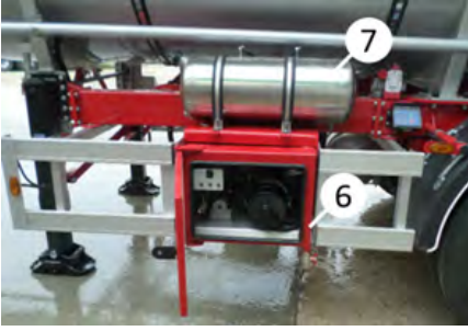
Isıtıcı dolabı ve mazot tankı
