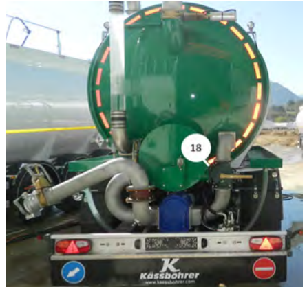
Boşaltım pompa giriş hattı
