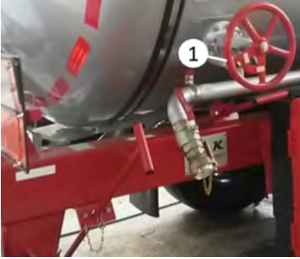
El çarklı dip vana açma kumandası
