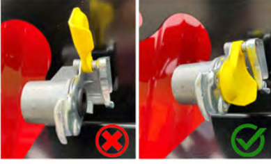
Bağlantı ağızlarının kapatılması
