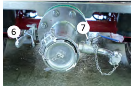
Emniyet vanası ve jet hava serbest üfleme düzeneği
