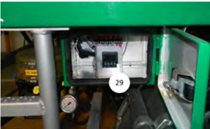
Merkezi yağlama elektronik sayıcı sistemi
