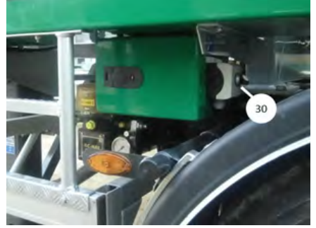
Merkezi yağlama açma kapama butonu
