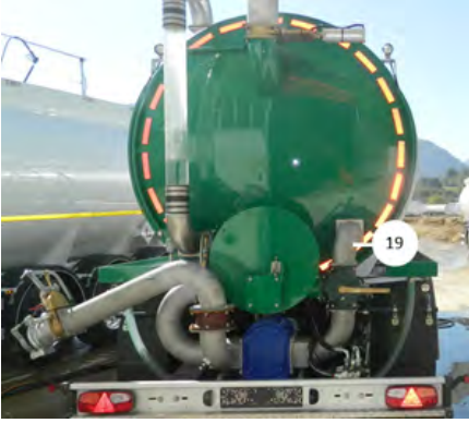
Tank karıştırma pompa çıkış hattı
