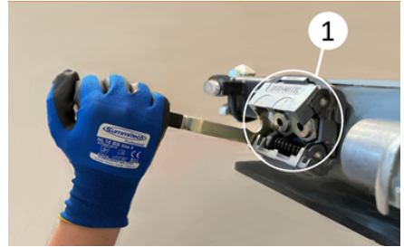
Duomatic kaplin bağlantısının yapılması
