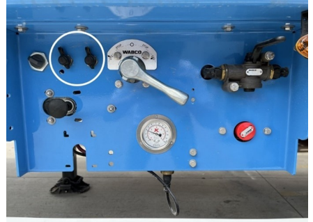
Kumanda dolabındaki dingil kaldırma mantar butonu
