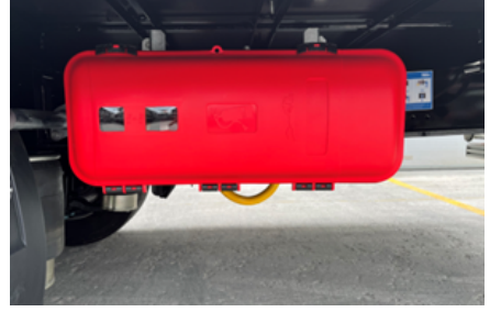
Yangın söndürme tüpü dolabı
