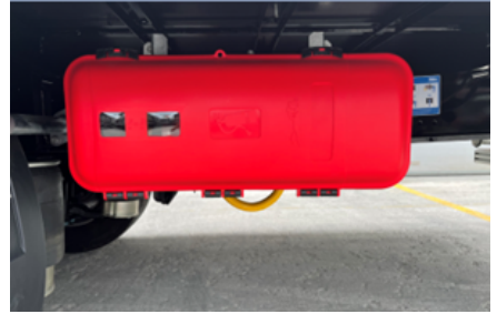
Yangın söndürme tüpü dolabı
