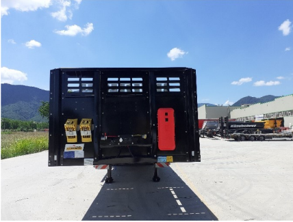
Ön panelde yangın söndürme dolabı
