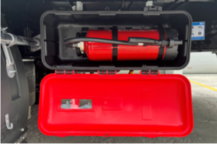
Yangın söndürme tüpü dolabının açılması
