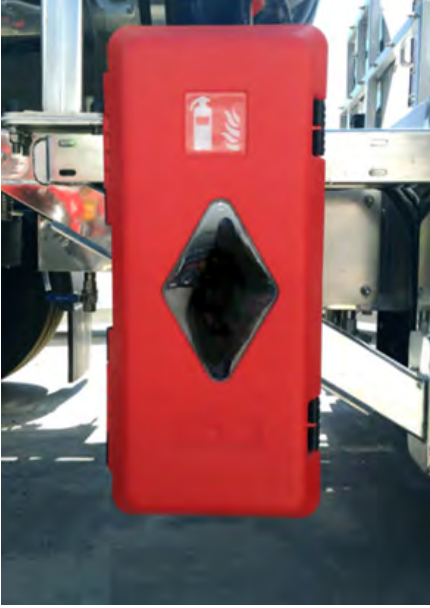
Yangın söndürme tüpü dolabı
