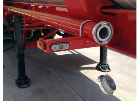
Akışkanlaştırıcı hava hattı
