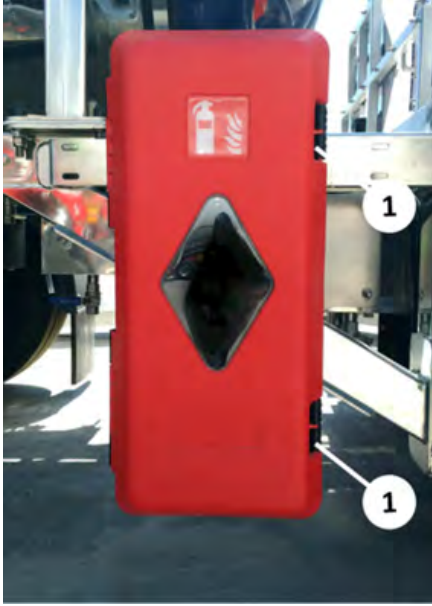
Yangın söndürme tüpü dolabı
