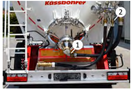
Akışkanlaştırıcı hava hattı ve vanası
