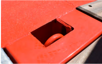
Gömülmüş yük bağlama halkası
