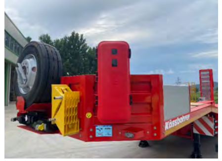
Yangın söndürme tüpü dolabı
