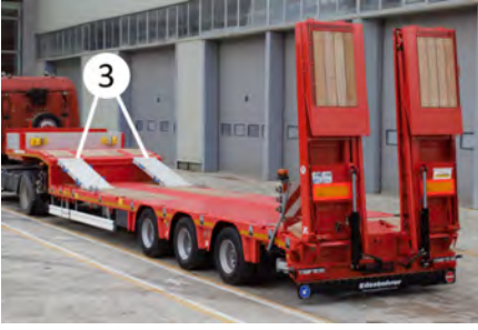
Deveboynu bölgesinde kullanılan rampa (3)
