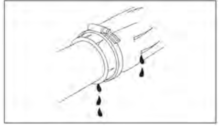
Hidrolik ve pnömatik bağlantılarında yağ sızıntısı
