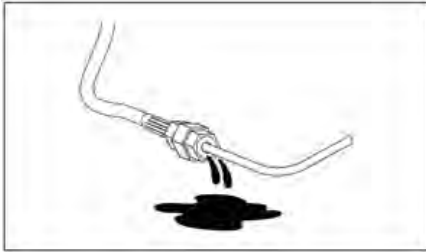
Hidrolik ve pnömatik bağlantılarında yağ sızıntısı
