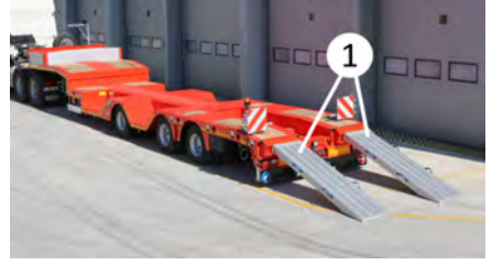
Tampon bölgesinde kullanılan rampalar (1)
