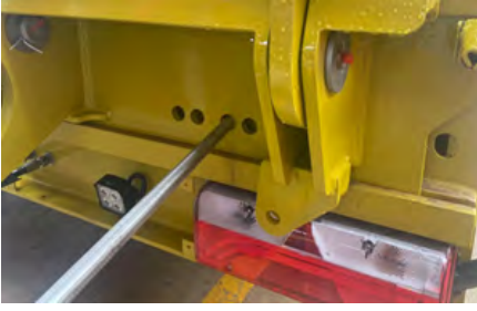
Mekanik rampanın levye yardımıyla hareket ettirilmesi
