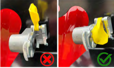
Bağlantı ağızlarının kapatılması
