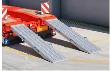
Tampon bölgesinde kullanılan rampalar
