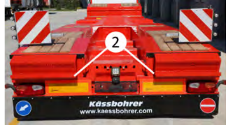
Tamponda bulunan rampa yerleştirme tırnakları
