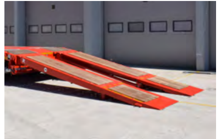
Hidrolik rampanın indirilmiş hali
