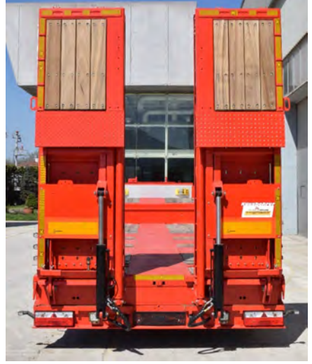
Sert ahşap taban rampa
