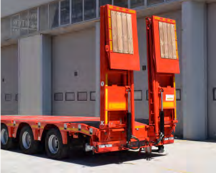
Hidrolik rampanın kaldırılmış hali
