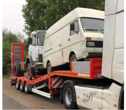
Hidrolik deveboynu rampa kullanım örneği
