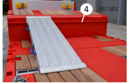
Deveboynunda bulunan rampa yerleştirme tırnakları
