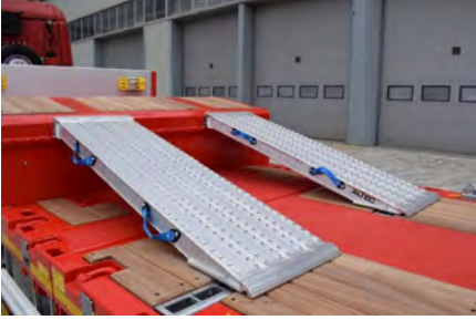
Deveboynu bölgesinde kullanılan alüminyum rampa
