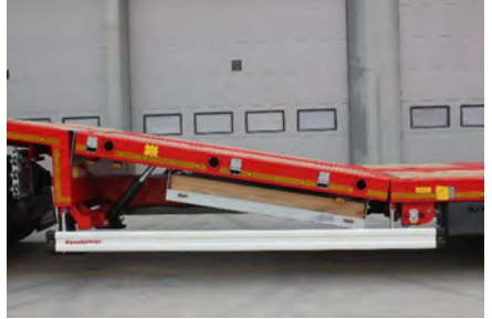
Rampanın üst pozisyonu
