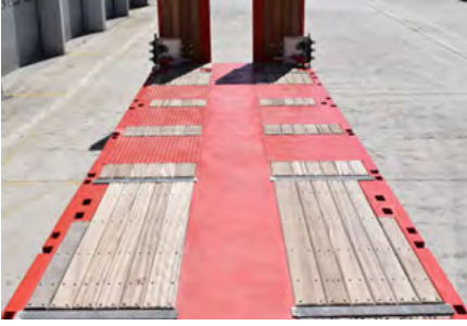
Ahşap döşeme taban
