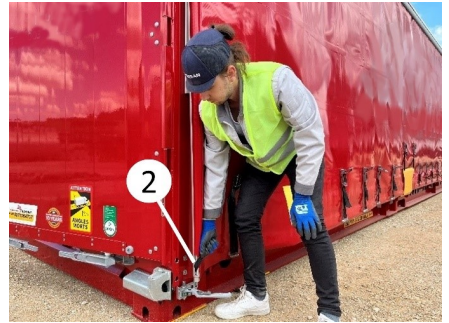
Perde profilinin çıkarılması
