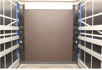
Darbelerden koruma için kontraplak yapı
