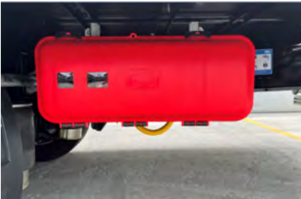
Yangın söndürme tüpü dolabı
