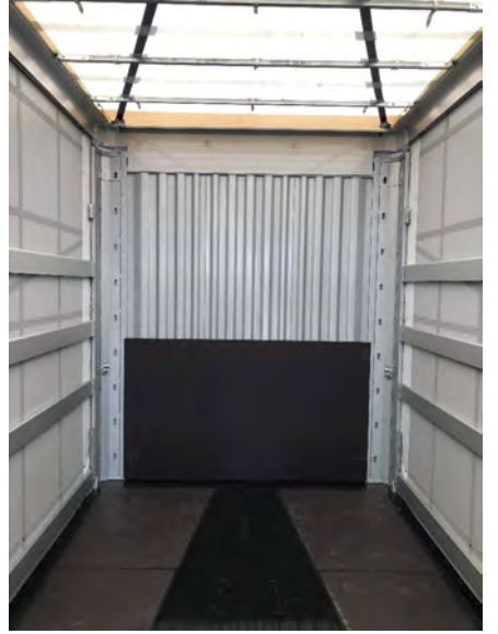
Darbelerden koruma için kontraplak yapı
