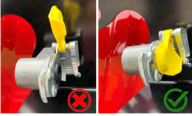
Bağlantı ağzlarının kapatılması
