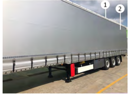
Gümrüklü kapaksız perde yapısı
