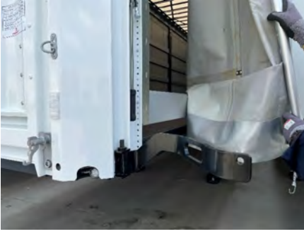
Perde borusu çıkarılması
