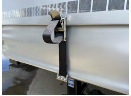
Kapaksız perde yapısı
