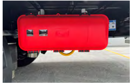
Yangın söndürme tüpü dolabı
