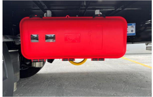
Yangın söndürme tüpü dolabı
