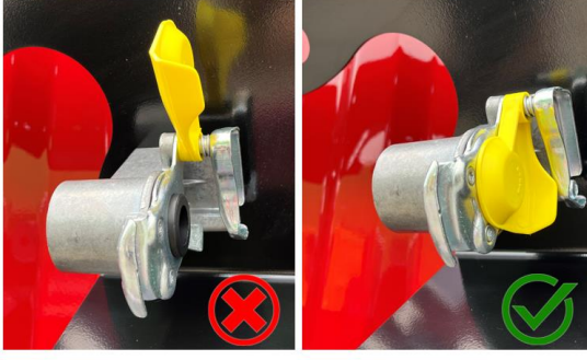
Bağlantı ağızlarının kapatılması
