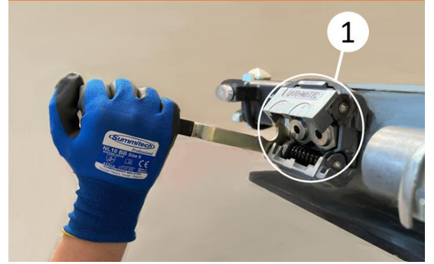
Duomatic kaplin bağlantısının yapılması
