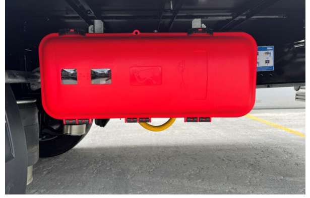
Yangın söndürme tüpü dolabı
