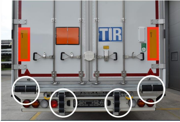
Rampa dayama takozları
