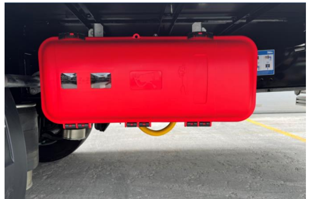
Yangın söndürme tüpü dolabı
