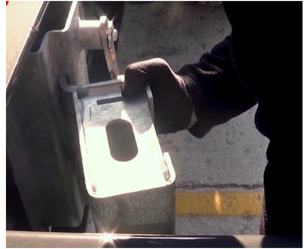
Konteyner kilit mekanizmasının stoklama yuvasına yerleştirilmesi
