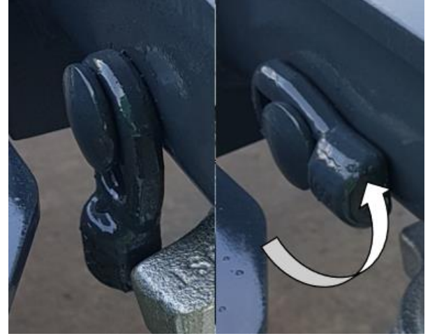
Emniyet sürgüsünün 90 derece döndürülmesi
