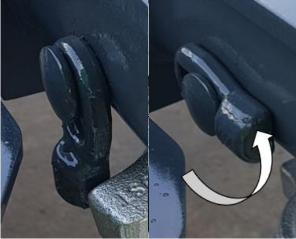
Emniyet sürgüsünün 90 derece döndürülmesi
