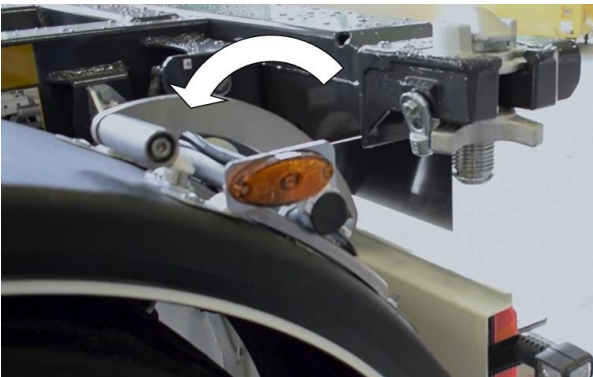
Uzatma kolunun yerine yerleştirilmesi
