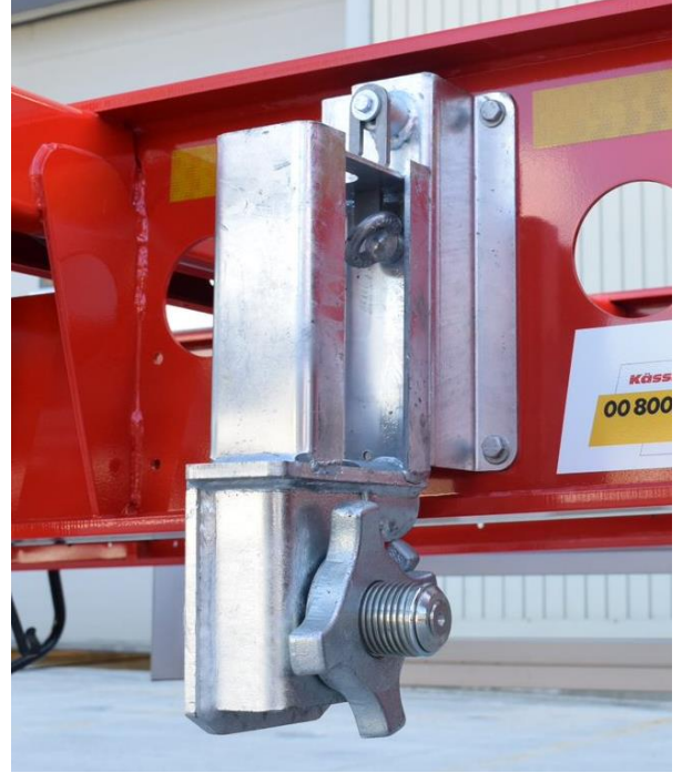
Konteyner kilit mekanizmasının stoklama yuvasına yerleştirilmiş görünümü
