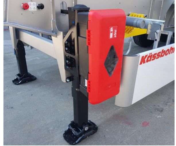
Yangın söndürme tüpü dolabı
