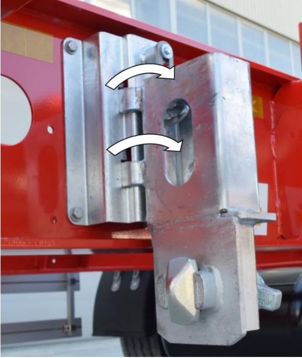
Konteyner kilit mekanizmasının çevrilmesi
