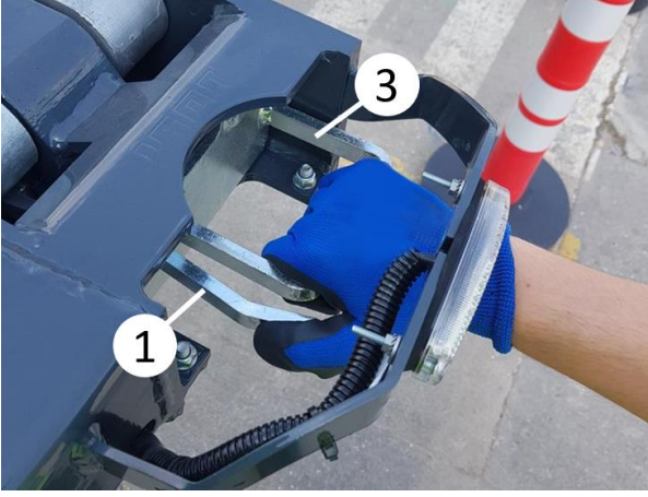
Kilit mandalının basılıp kolun çekilmesi
