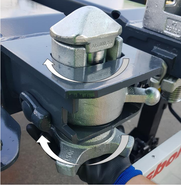
Yükleme konumuna getirilmesi
