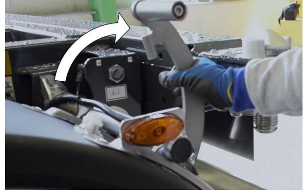
Uzatma kolunun saat yönünde çevrilmesi
