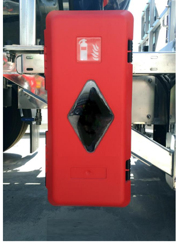
Yangın söndürme tüpü dolabı
