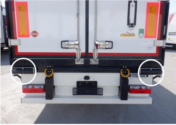
Rampa dayama takozları
