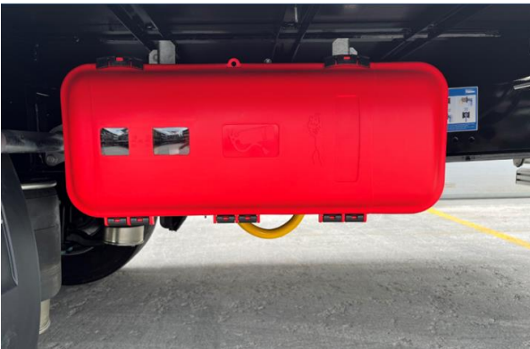
Yangın söndürme tüpü dolabı
