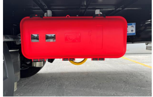
Yangın söndürme tüpü dolabı
