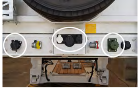
Elektrik bağlantılarını yapınız.
