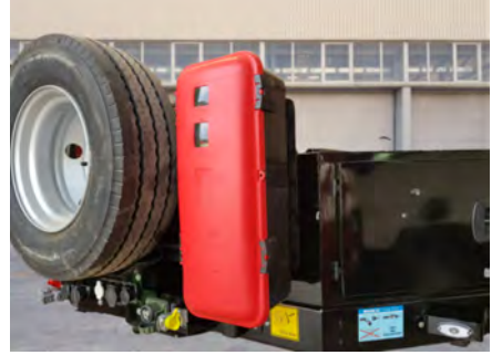
Yangın söndürme tüpü dolabı
