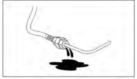
Hidrolik ve pnömatik bağlantılarında yağ sızıntısı
