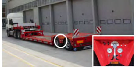
İndirme — kaldırma valfinin lowbed aracındaki konumu
