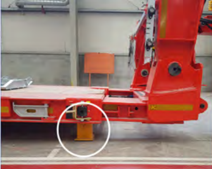
Tekerlek takozlarının yerleştirilmesi
