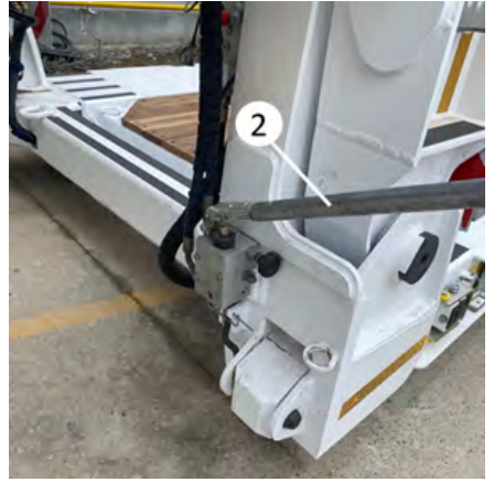
Acil durum el pompasını kullanırken pompa kolu olarak kullanmak (2)
