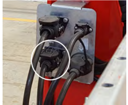
EBS, Aydınlatma ve Dümenleme Elektrik Soketleri
