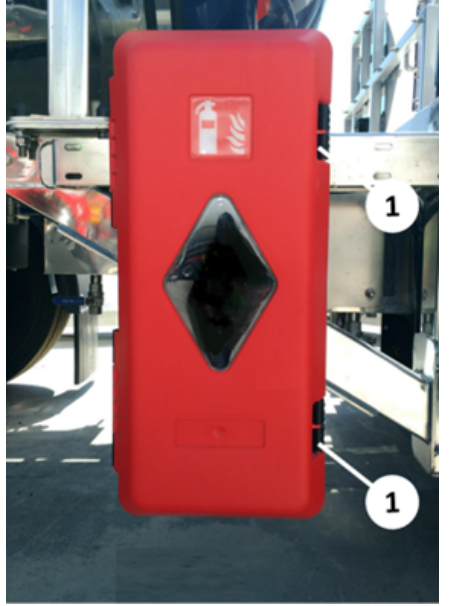
Yangın söndürme tüpü dolabı
