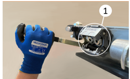
Duomatic kaplin bağlantısının yapılması
