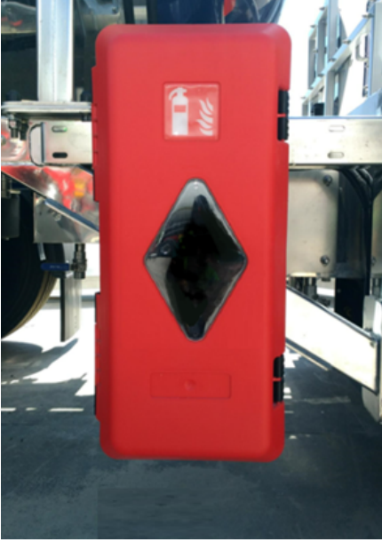
Yangın söndürme tüpü dolabı
