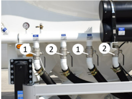
Jet hava ve akışkanlaştırıcı hava bağlantıları
