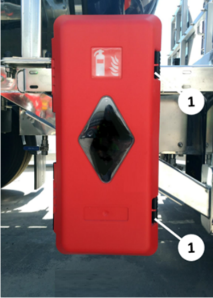
Yangın söndürme tüpü dolabı
