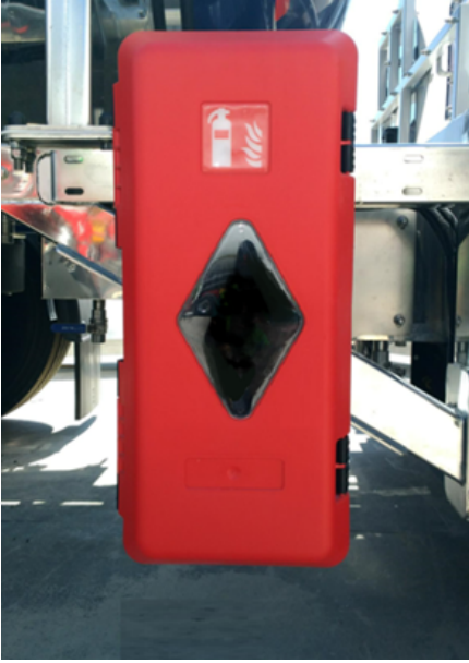
Yangın söndürme tüpü dolabı
