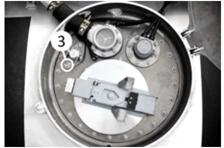
Seviye kontrol çubuğunun mühürlenmesi
