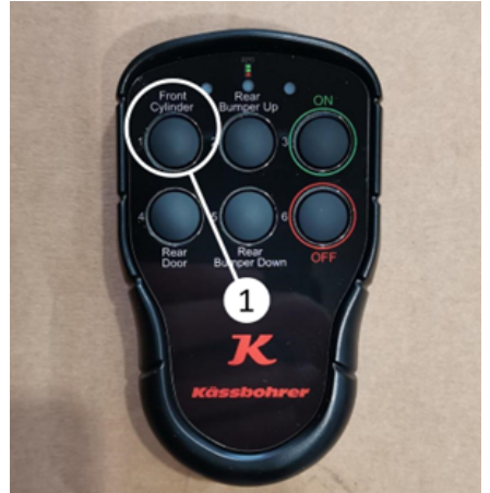
Uzaktan kumanda üzerinden küvetin indirilmesi
