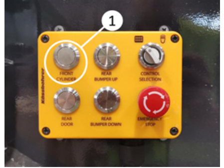
Front cylinder butonuna basılıp küvetin indirilmesi
