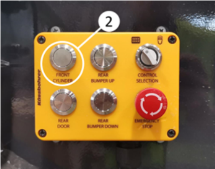
Front cylinder butonuna basılıp küvetin kaldırılması
