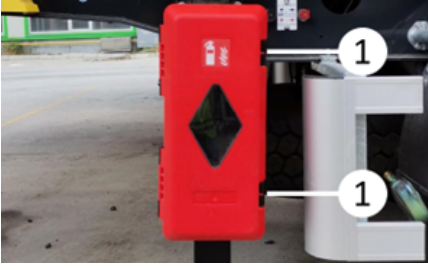
Yangın söndürme tüpü dolabının açılması
