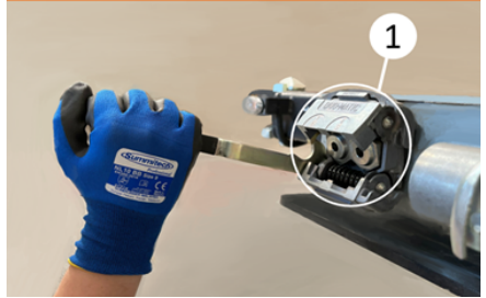
Duomatic kaplin bağlantısının yapılması
