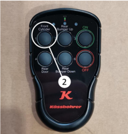
Uzaktan kumanda üzerinden küvetin kaldırılması
