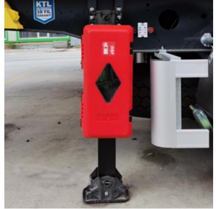
Yangın söndürme tüpü dolabı
