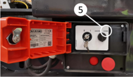
Kontrol ünitesinden brandanın kapatılması
