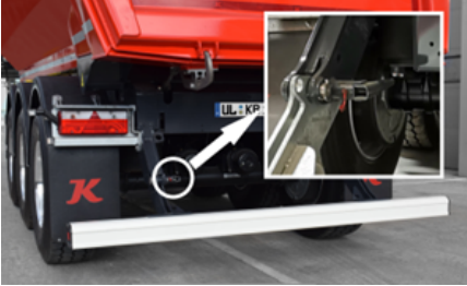
Kalkar tamponun kaldırılması
