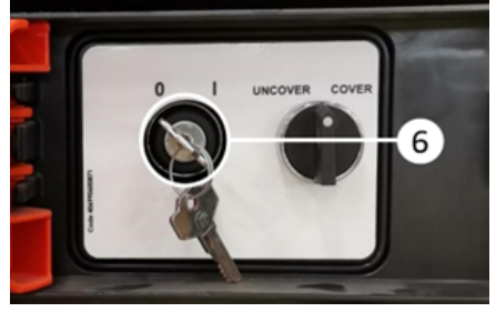
Branda kontrol ünitesinin kapatılması
