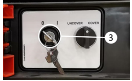
Branda kontrol ünitesinin kapatılması
