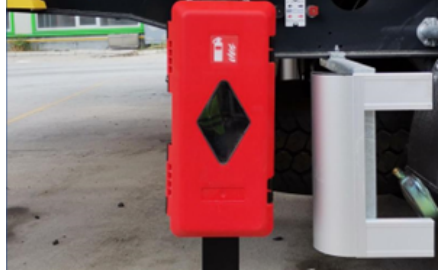
Yangın söndürme tüpü dolabı
