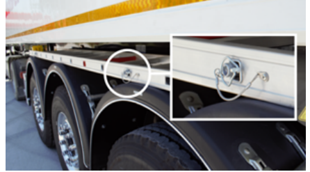
Seyyar merdiven piminin çıkarılması
