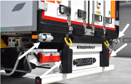
Schock absorber ve dikey rampa dayama takozları
