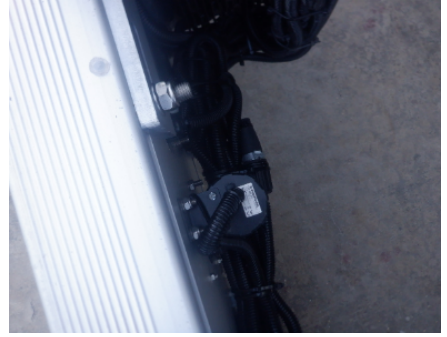
Gerı vites sesli ikaz sistemi sensörü
