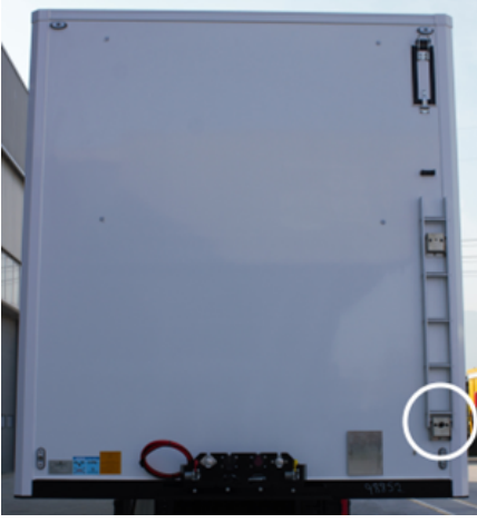
Ön panel merdiveni
