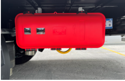
Yangın söndürme tüpü dolabı
