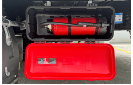
Yangın söndürme tüpü dolabının açılması
