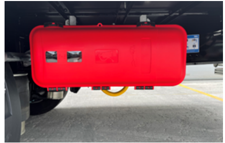
Yangın söndürme tüpü dolabı
