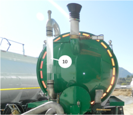
Tank seviye göstergesi
