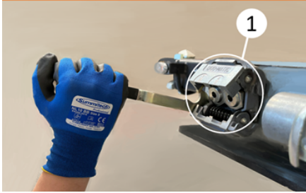
Duomatic kaplin bağlantısının yapılması
