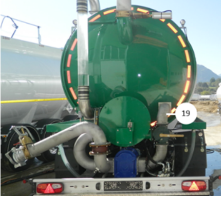
Tank karıştırma pompa çıkış hattı
