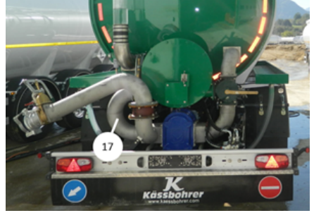
Tank karıştırma pompa giriş hattı
