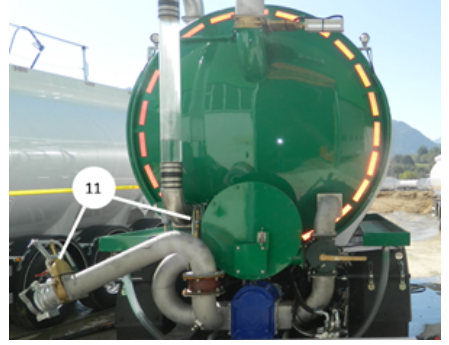
Mekanik kontrollü vana
