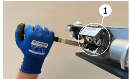
Duomatic kaplin bağlantısının yapılması
