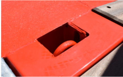
Gömülmüş yük bağlama halkası
