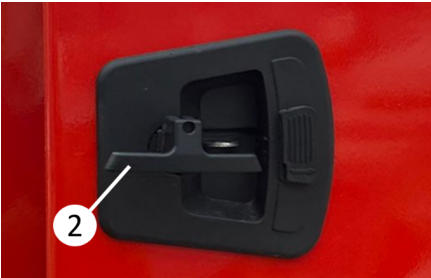
Kilit mandalının çıkarılması ve çevrilmesi
