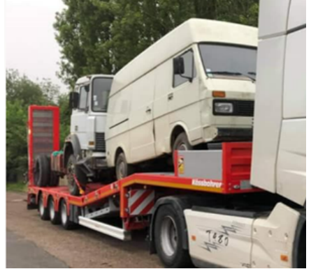
Hidrolik deveboynu rampa kullanım örneği
