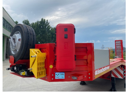
Yangın söndürme tüpü dolabı
