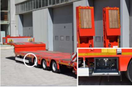
Kumanda dolabının lowbed araçındaki konumu
