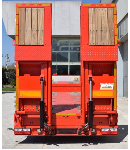
Sert ahşap taban rampa
