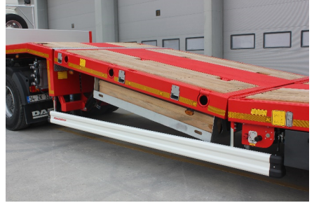
Hidrolik deveboynu rampa
