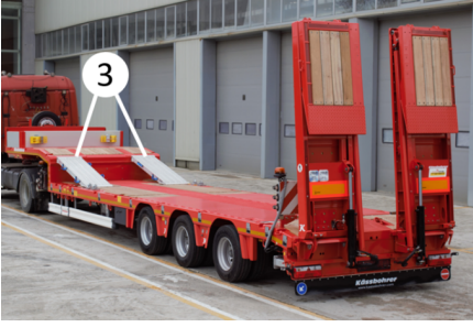
Deveboynu bölgesinde kullanılan rampa (3)
