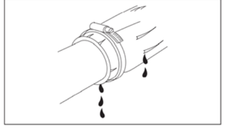
Hidrolik ve pnömatik bağlantılarında yağ sızıntısı
