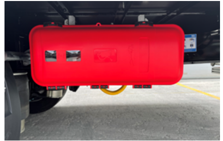
Yangın söndürme tüpü dolabı
