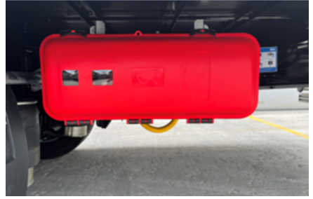
Yangın söndürme tüpü dolabı
