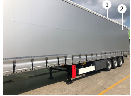
Gümrüklü kapaksız perde yapısı
