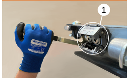
Duomatic kaplin bağlantısının yapılması
