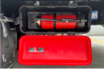
Yangın söndürme tüpü dolabının açılması
