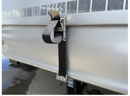
Kapaksız perde yapısı
