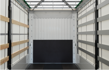
Darbelerden koruma için kontraplak yapı
